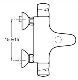
Спецификация продукта: Настенный термостатический смеситель для ванны/душа. E71071. Коллекция: STOMB+. BEC: 3,5 кг. ТИП: Термостатический. PACXOД ВОДЫ: 20 л/мин при давлении 3 бар. МЕХАНИЗМ: Термостатический картридж. PA3METKA ОТВЕРСТИЙ: 150 ± 15 мм. ЭКОНОМИЧНОЕ ПОТРЕБЛЕНИЕ: Экономия воды и энергии. ОДНОРЫЧАЖНЫЙ СМЕСИТЕЛЬ: ТЕРМОСТАТИЧЕСКИЙ ОДНОРЫЧАЖНЫЙ СМЕСИТЕЛЬ. УСТАНОВКА: Настенные. Механизм экономии воды, кнопка «Eco». Аэратор с антиизвестковым покрытием. Обратный клапан в комплекте.
